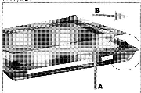
La montarea geamului interior (1), asigurați-vă că latura inscripționată este orientată spre interior. Este importantă introducerea colțului inferior al geamului în fanta de plastic inferioară. Împingeți piesa din plastic spre cadru până când auziți un clic.
