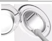
După fiecare spălare, verificați dacă în tambur nu au rămas substanțe străine. Dacă orificiile din burduf indicate în figură sunt înfundate, desfundăți-le cu o scobitoare.
